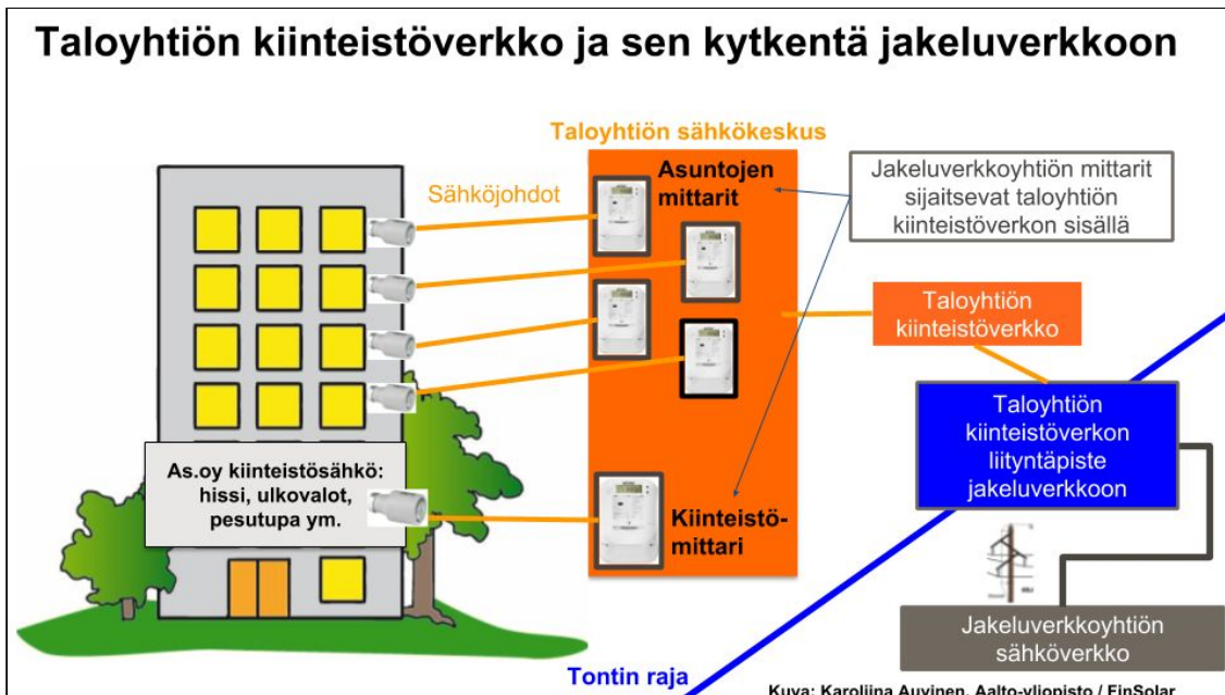
Kuva 1: Taloyhtiön kiinteistöverkko ja sähkömittarit
